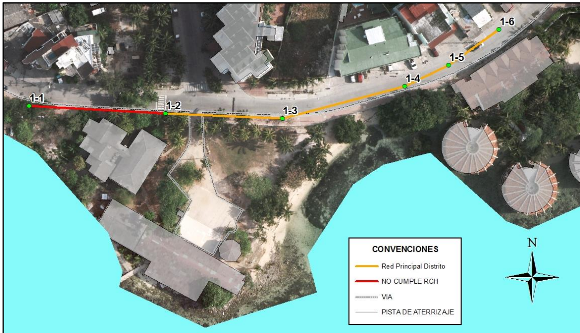
Figura 9-11 Tramos que no cumplen el chequeo de capacidad hidráulica. Perfil 3 Distrito 1. Planta
