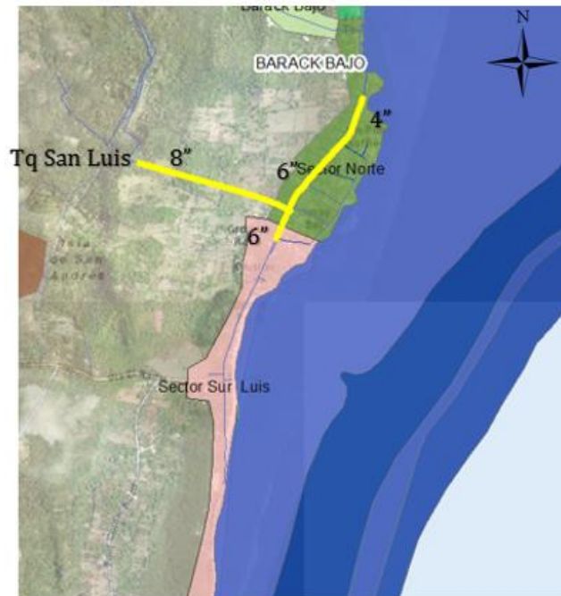
Figura 8-75 Tramos de tuberías en asbesto cemento
