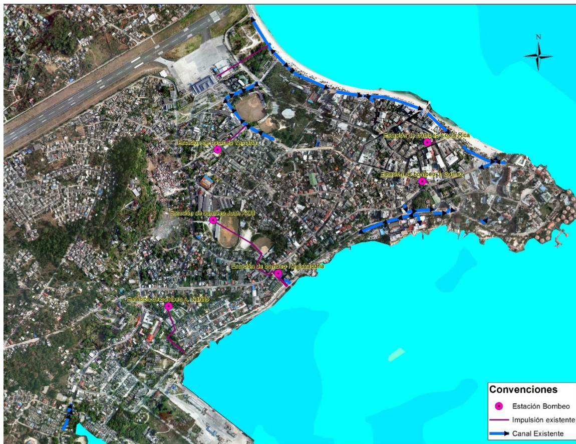
Figura 10-3 Infraestructura para el manejo y evacuación de las aguas lluvias según el diagnóstico del plan maestro.
