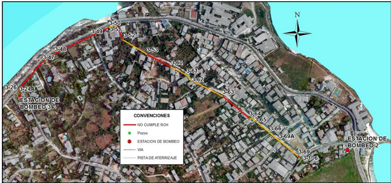
Figura 9-29 Tramos que no cumplen el chequeo de capacidad hidráulica. Perfil 1 Distrito 3. Planta
