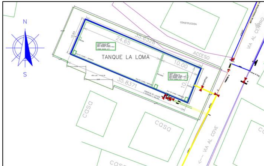
Figura 8-40 Válvulas en el tanque de la Loma
