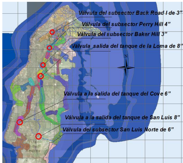
Figura 8-41 Localización de válvulas compuerta en mal estado
