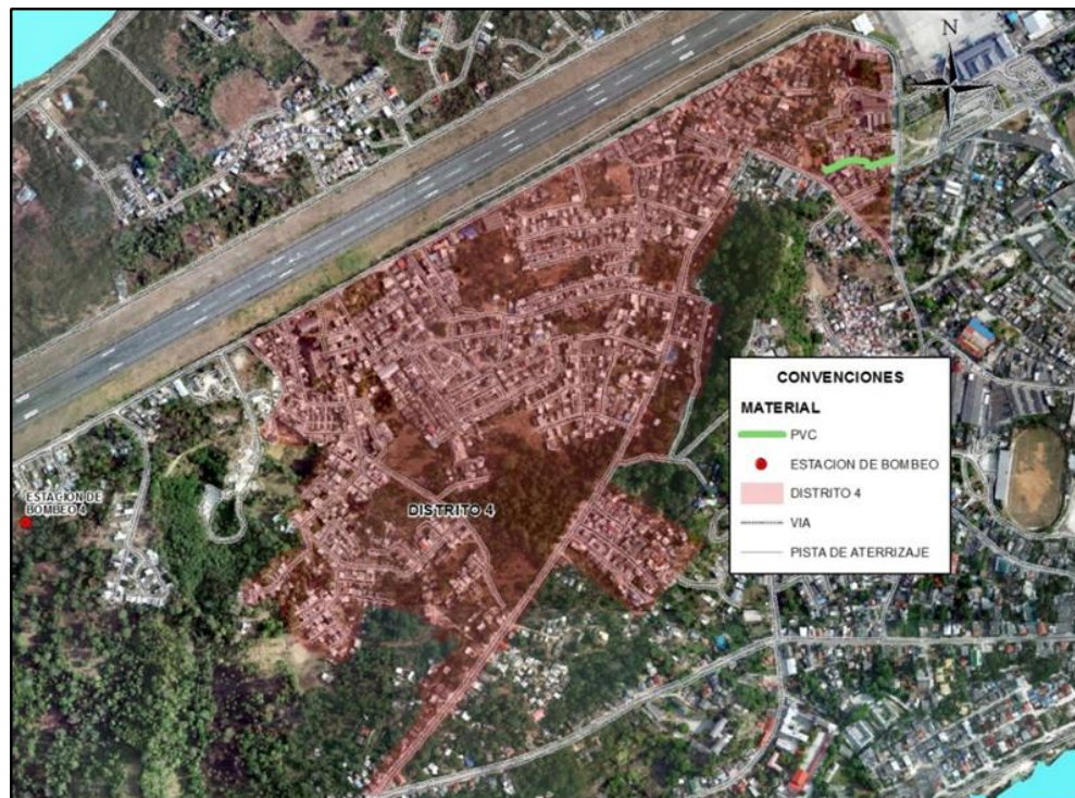
Figura 9-45 Redes de Alcantarillado Sanitario por material Distrito 4
