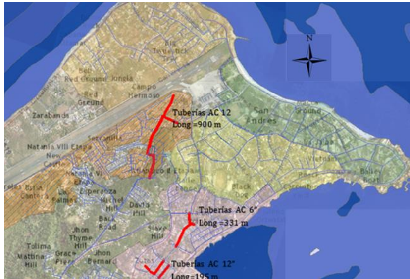
Figura 8-59 Tramos de tuberías en asbesto cemento
