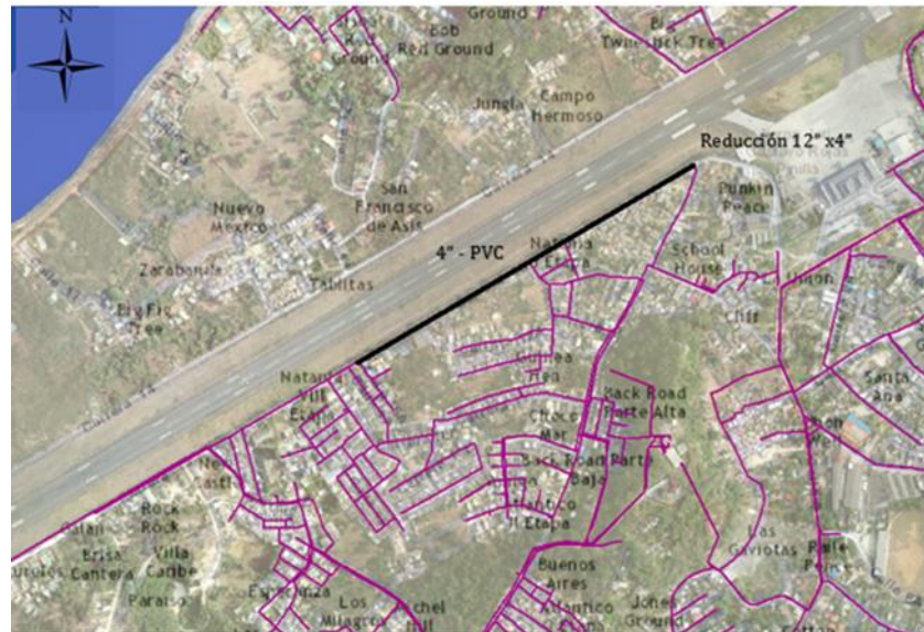
Figura 8-58 Red principal sector Natania con insuficiencia de capacidad hidráulica
