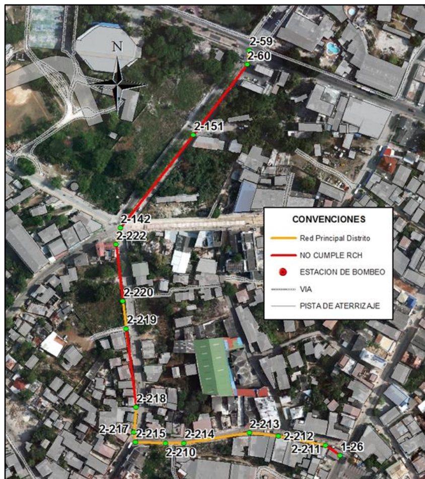
Figura 9-22 Tramos que no cumplen el chequeo de capacidad hidráulica. Perfil 2 Distrito 2. Planta
