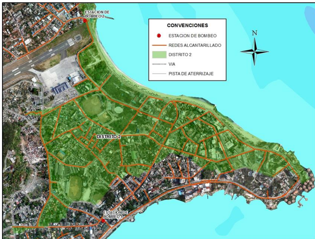
Figura 9-16 Distrito de Alcantarillado Sanitario 2
