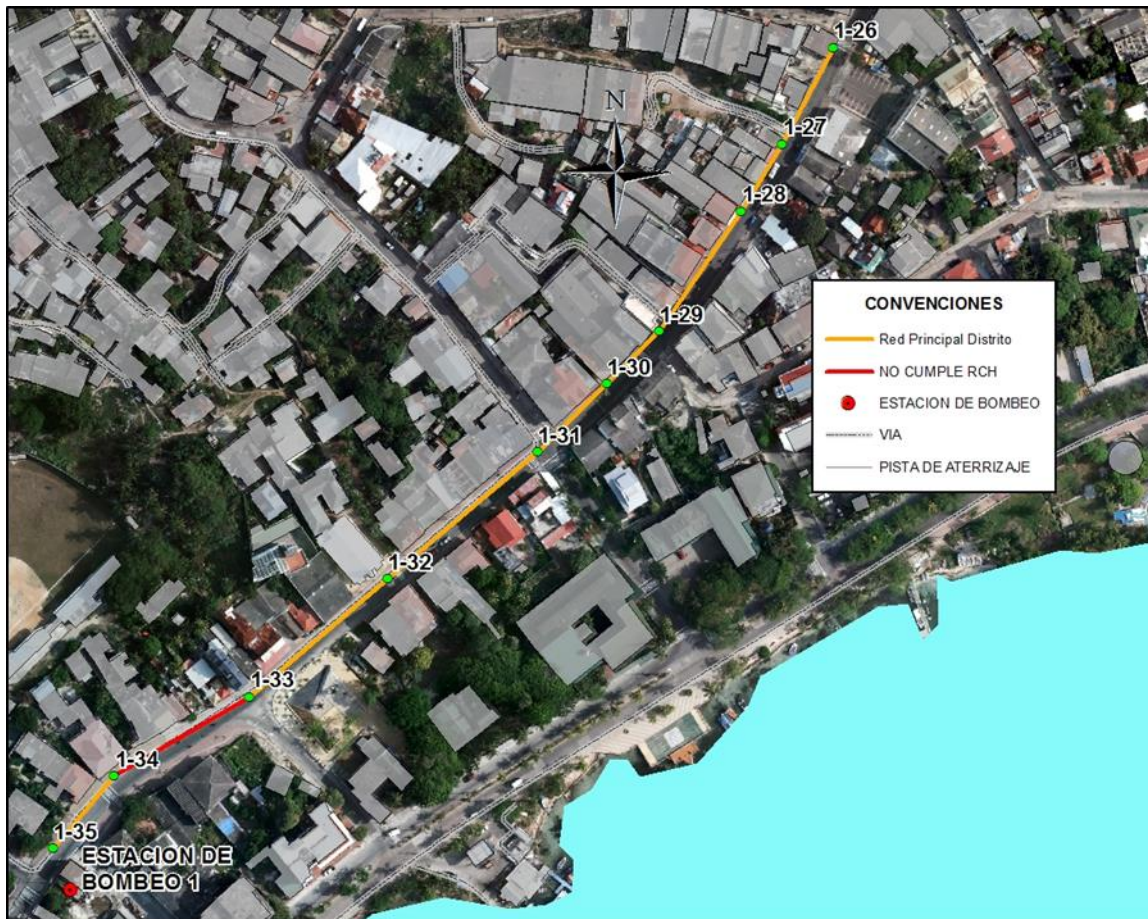
Figura 9-15 Tramos que no cumplen el chequeo de capacidad hidráulica. Perfil 5 Distrito 1. Planta
