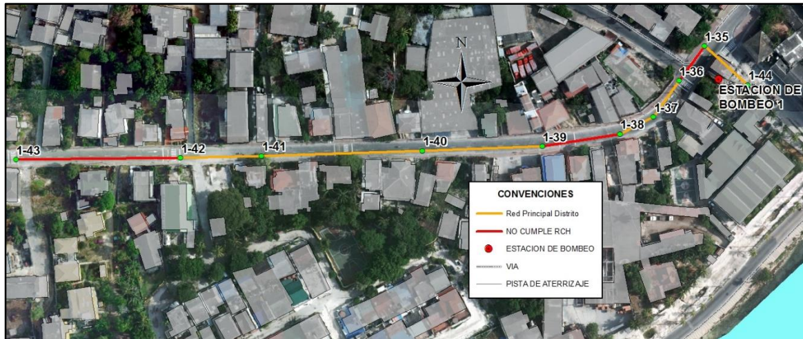
Figura 9-13 Tramos que no cumplen el chequeo de capacidad hidráulica. Perfil 4 Distrito 1. Planta
