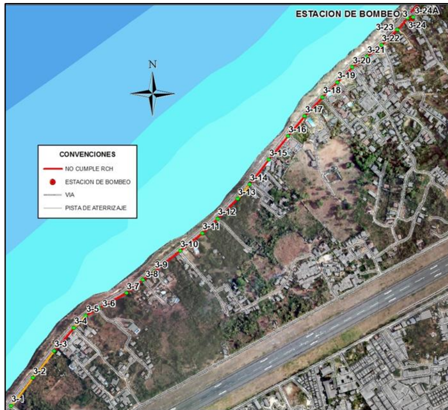
Figura 9-33 Tramos que no cumplen el chequeo de capacidad hidráulica. Perfil 3 Distrito 3. Planta
