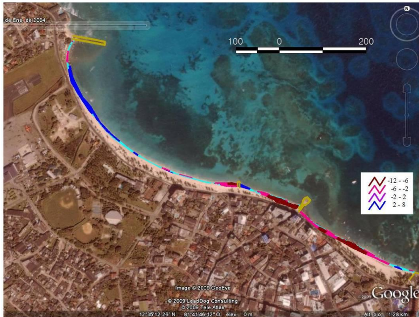
Figura 42. Evolución de todas las líneas de costa entre 2004 y 2008 (tomado de FONADE y Gobernación del Archipiélago San Andrés, Providencia y Santa Catalina, 2010a).
